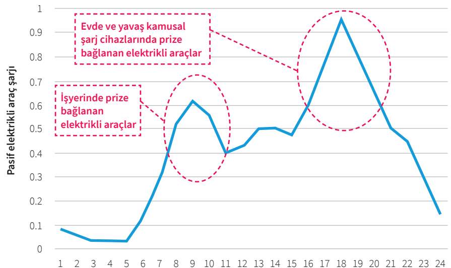
Şekil 22: Pasif (kontROLSÜZ) elektrikli araç şarjının sabah ve akşam talep puant talebini gösteren tipik günlük profili
