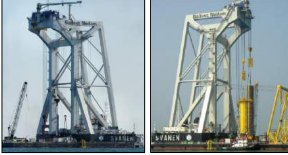
Şekil 11.18. Ballast Nedam Svanen montaj gemisi.
