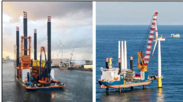
Şekil 11.17. Gemini DRES nakliye ve montaj faaliyeti.
