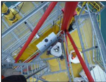
Şekil 4.54. IJMuiden denizüstü meteoroloji ölçüm istasyonuna konulan LIDAR.
