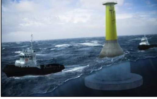
Şekil 10.18. Ağırlık temel gemi ve tugboatlar ile deniz üzerinde yüzdürülme animasyon.
