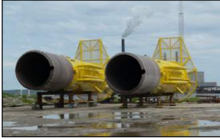
Şekil 11.7. OWEZ DRT temel geçiş parçası.
