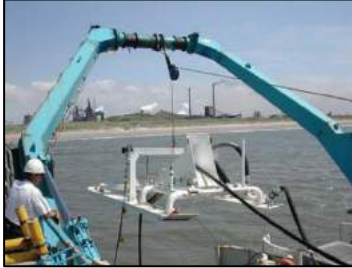
Şekil 11.20. Denizaltı kablo kazıcı.
