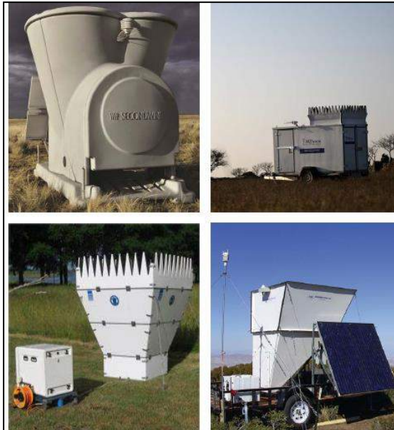
Şekil 4.10. En yaygın kullanılan SODAR cihazları (saat yönünde: Second Wind Triton; AQSystem AQ500; Metek PCS2000-24/LP; ASC 4000i).
