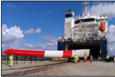
Şekil 10.28. DRT kanadın gemiye yüklenmesi.
