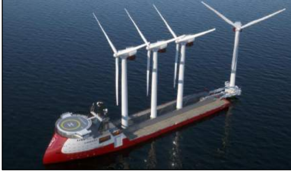
Şekil 7.11. DRT tek parça nakliye.
