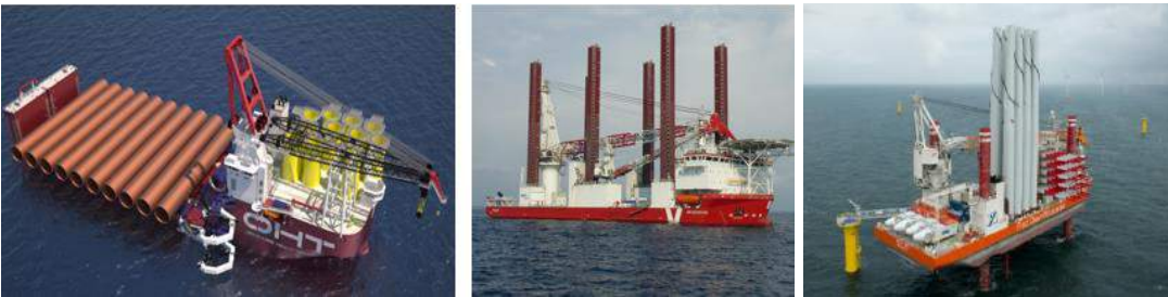
Şekil 7.10. DRT parça bazlı nakliye.
