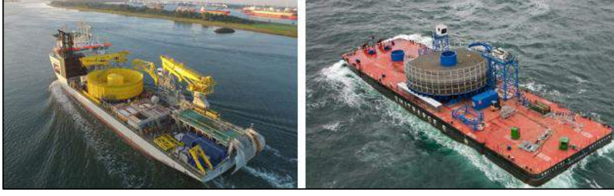
Şekil 9.30. Azimuth DRES denizaltı kablo montaj gemileri.
