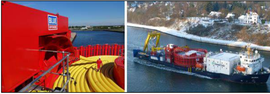
Şekil 9.31. Baltic 2 DRES kablo kablo montaj gemileri.
