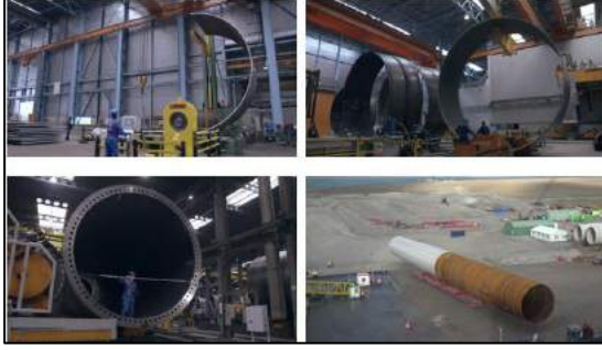
Şekil 9.17. Sif Group tek kazıklı temel (monopile) üretimi.
