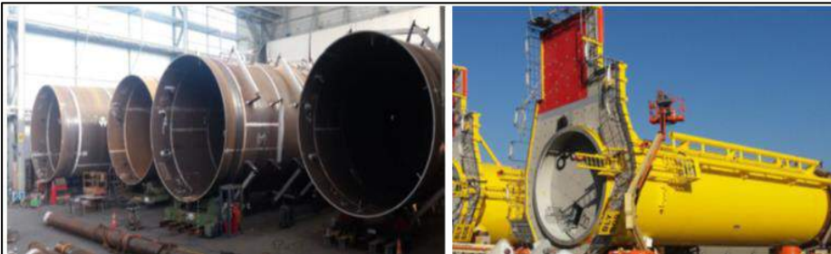
Şekil 10.44. Nakliyeyle hazır jale gelmiş DRT temeli.
