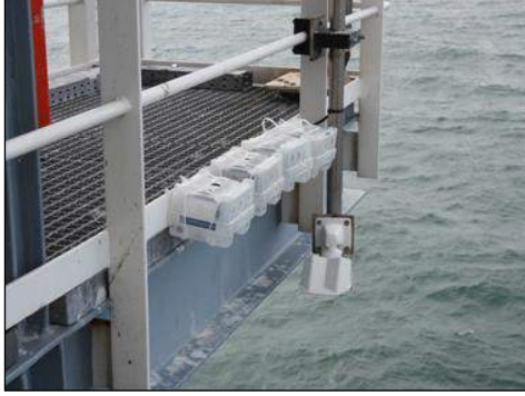
Şekil 4.48. Korozyon koruma ölçümleri.
