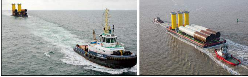
Şekil 10.15. Tekil kazıklı temel gemi güvertesinde taşıma.
