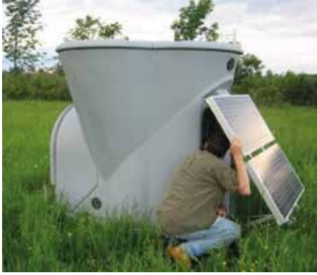
Şekil 20: SODAR ölçüm sisteminden bir görünüş (Kaynak [55]’ten uyarlanmıştır).
