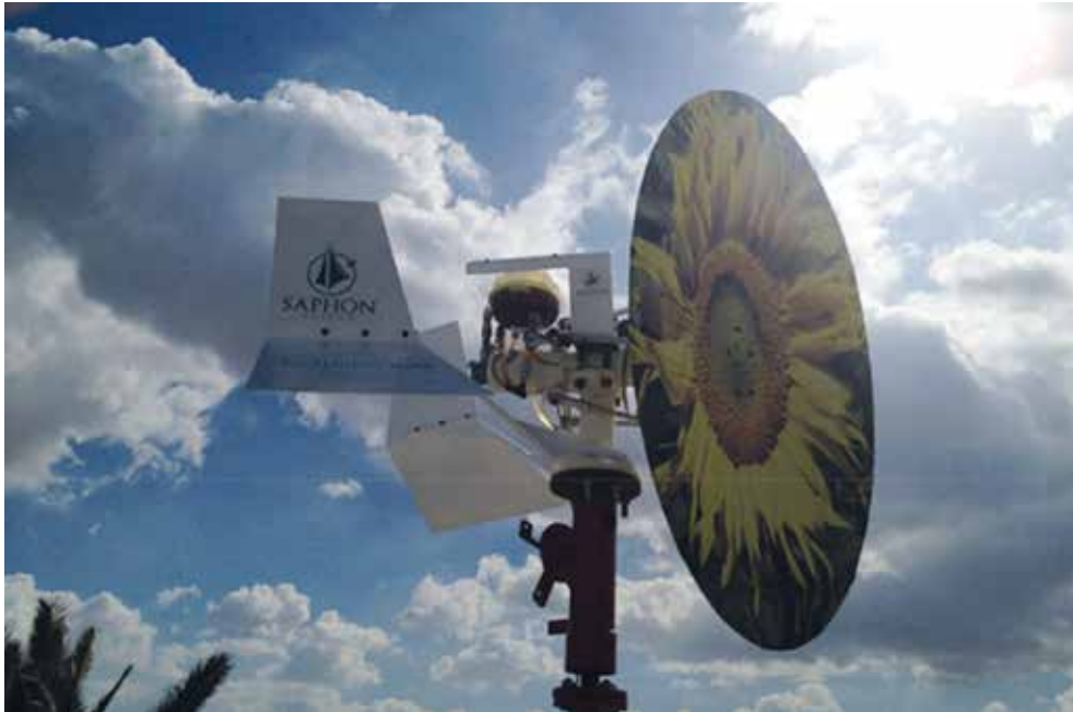
Şekil 33: Kanatsız rüzgâr türbini örneği (Kaynak [80]'den uyarlanmıştır).
