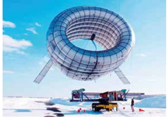
Şekil 35: Uçan rüzgâr türbini örneği (Kaynak [82]'den uyarlanmıştır).
