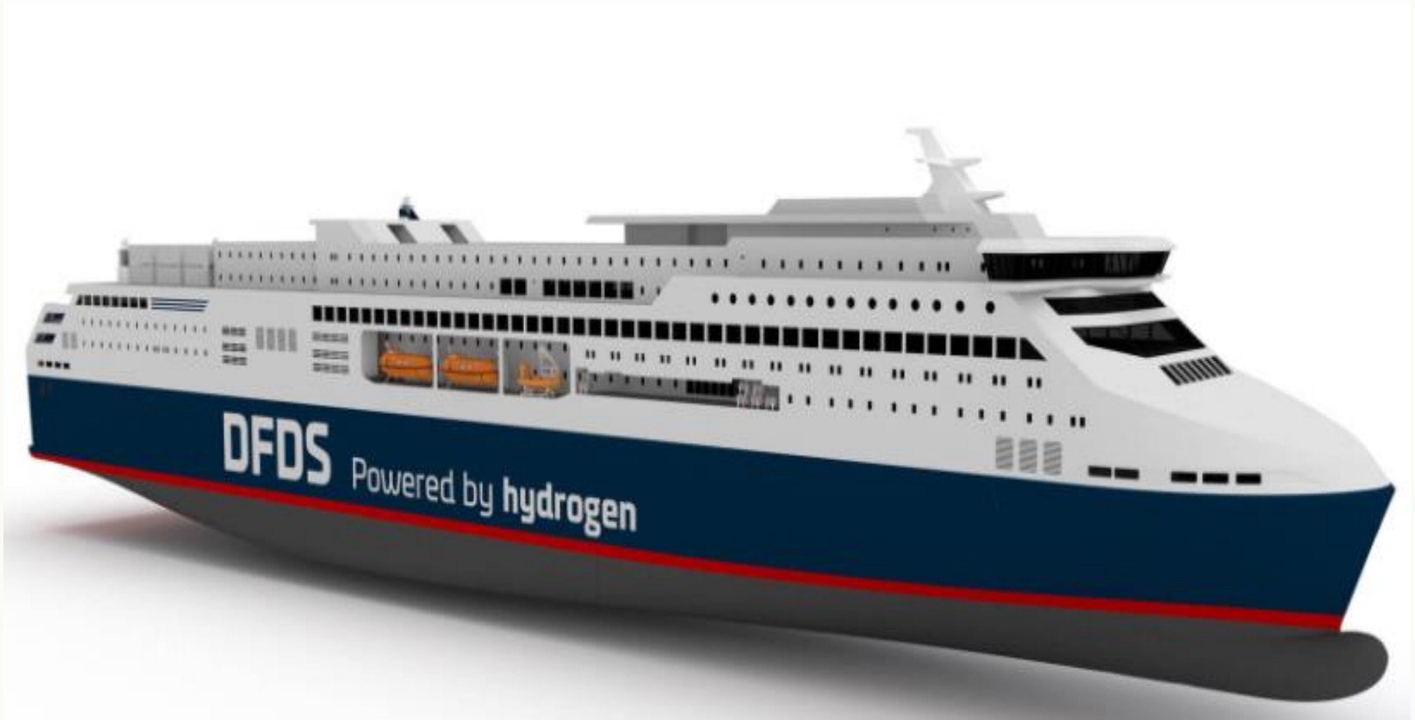
Hidrojen yakıt h creli (23 MW) feribot projesi – Norve , 1800 yolcu ve 380 otomobil ta ıma kapasitesi, hedef 2027
