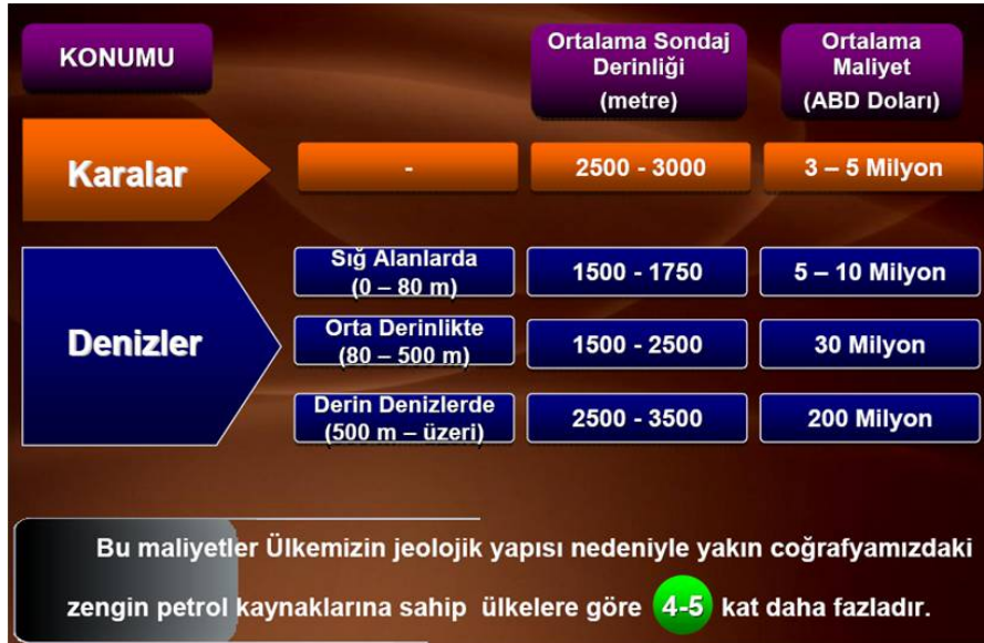
Şekil 19: Ülkemiz Kara ve Denizlerinde Ortalama Sondaj Maliyetleri Kaynak: PİGM
