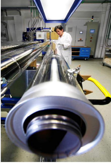
Parabolik oluk tipi kollektör ısı toplama borusu imali ve detay resmi (SCHOTT A.G.)
